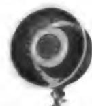
**Druckkammer-Lautsprecher**, witterungsunempfindlich, mit hohem Frequenzbereich. Besonderheit: kleine Abmessung, schwenkbar auf Fuß, sehr gut geeignet für Ruf- und Telefonanlagen sowie Musikübertragungen im Freien und auf Booten. Daten: Mod. RH 3, Impedanz 8 Ω, Frequenzbereich 75-6500 Hz, Maße 75 mm φ, 41 mm Höhe **DM 23.15**
