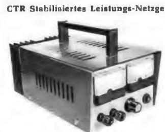
**CTR Stabilisiertes Leistungs-Netzgerät TNG 5** für Werkstatt u. Labor, im Metall-Flachgehäuse. Eingebaute, beleuchtete Meßinstrumente für Strom und Spannung, erdfreier Ausgang sowie elektronische Strombegrenzung. Ausgangsspannung: 3–25 V stufenlos regelbar, max. 3 A, Bestückung: B 40 C 5000, 2 N 3055, BD 137, Präz.-Spannungsregler L 123 B (LM 723), Maße: 155 × 110 × 265 mm, Gew.: ca. 3 kg **298.—**
