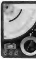
**CTR-Multitester 620 N**, m. Spiegelskala u. Überlastungsschutz Innenwiderst.: 20 000 Ω/V =, 10 000 Ω/V ~, DC: 0–5–25–50–250–500–2500 V, AC: 0–10–50–100–500–1000 V, DC: 0–50 µA, 0–2,5 mA, 0–250 mA, R: 0 bis 80 kΩ, 0–8 MΩ (300 Ω bzw. 30 kΩ), C: 10 pF–0,01 µF, 0,001 µF–0,1 µF, db: –20 bis +22. Maße: 115 × 83 × 28 mm, Gew.: 250 g, Zubehör: 2 Prüfschnüre u. Batt. **39.50** Lederlasche **4.25**
