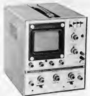
Bild 3. Zweistrahloszillograf
