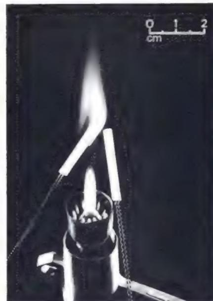
Hochtemperatur-Thermistor HT 103/750 für Temperaturen bis + 1000 °C
