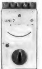
**Universalmesser UNI 7** m. Spiegelskala, 20 000 Ω/V, 32 Meßbereiche ± 1,5 % Genauigkeit. DC: 100 500 mV, 2,5–10–50–100–250–500–1000 V; DC: 50–500 µA, 2,5–10–50–250 mA, 1–5 A, AC: 2,5–10–50–250–500–1000 V, AC: 250 µA, 2,5–10–50–250 mA, 1–5 A, R: 0–10 kΩ, 0–10 MΩ. Maße: 215 × 115 × 85 mm, Gew.: 1235 g, Komplett mit Batterie **199.50**
