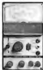
**HANSEN-Transistor-Tester HM 60 A**, verbesserte Ausführung, z. Messung von Transistoren, Leistungstrans., Dioden usw. Leichte Einstellung durch Einknopf-Bedienung. Bereiche: ICO 0–50 µA, Leistungstrans.: 0–1 mA, a: 0,7–0,9967, b: 0–200, Widerstände: 0–1 MΩ, Betr.-Spg.: 9-V-Batt. Maße: 180 × 110 × 80 mm, Gew.: 780 g **69.50**
