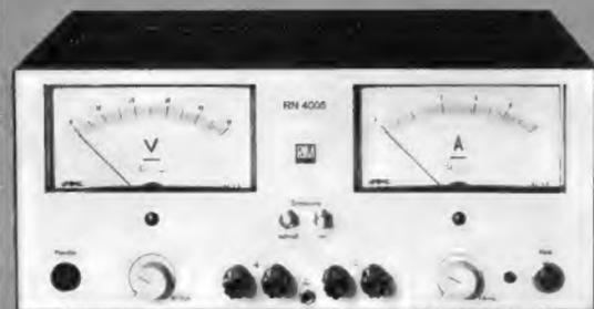
Gleichspannungsnetzgerät »RN 4005«
