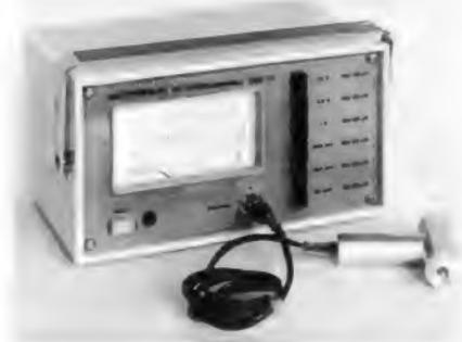
▲ Bild 4. Hochfrequenz-Millivoltmeter MUK 11
