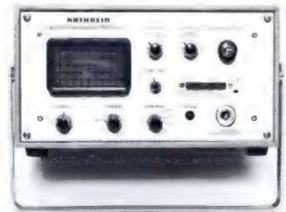
Bild 6. Das Impulsreflektometer für Kabelprüfungen
