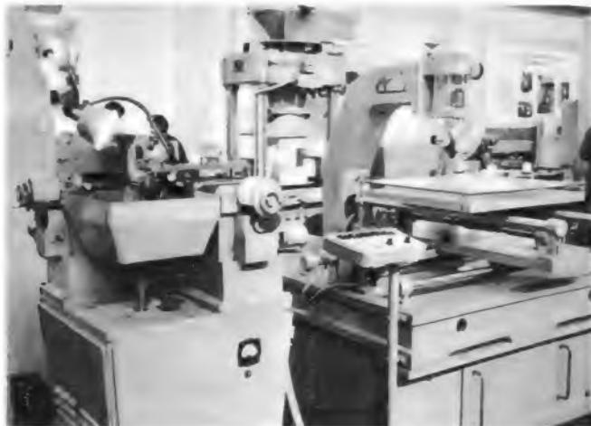
Bild 2. Funkerosionsfräser (links), daneben die zugehörige Steueranlage mit Lichtpunktabtastung der Zeichnungsvorlage. Der Maßstab 30 : 1 war fixiert und konnte nicht verändert werden (Aufnahmen: Groll)
