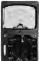
**CTR-Taschenlester TS 60 R** mit Bereichsschalter Innenwiderstand: 1000 Ω/V DC: 0–15–150–1000 V, 1–150 mA AC: 0–15–150–1000 V Widerstand: 0–1000 kΩ Maße: 56 × 90 × 29 mm Gewicht: 150 g Zubehör: 2 Prüfschnüre und Batterie **21.50**
