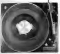
Spielt und wechselt bis zu 8 Platten, alle Geschwin-digkeiten, leichter Rohrton-arm, mech. Aufsetzhilfe (Tonarmlift), Antiskating-Einrichtung, einstellbar 2/4/6 p, großer Plattenteller (28 cm), Stereo-Kristallsystem (internat. Systembefesti-gung), Gleichlauf: Wow unter 0,2 %, Flutter unter 0,06 %, Netz 220-250 V,
