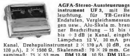
**AGFA-Stereo-Aussteuerungsinstrument UF 3**, mit Beleuchtung, für TB-Geräte, Endstufen, Vergleichsmessungen usw., Alu-Skala m. brauner Beschriftung – 15 bis 0 bis +3 dB je Kanal, eingeb. Lämpchen 12 V, 20 mA pro Kanal, Drehspulinstrument 2 × 170 μA (0 dB, ca. 120 μA), 2 × 1500 Ω, Skalenmaß: 70 × 29 mm, Gesamtmaß: 75 × 53 mm DM 12.50 10 St. DM 115.—
